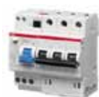
DS203 M, 10kA, 3 pol, Type A, C-karakteristikk, 32A, 30mA
